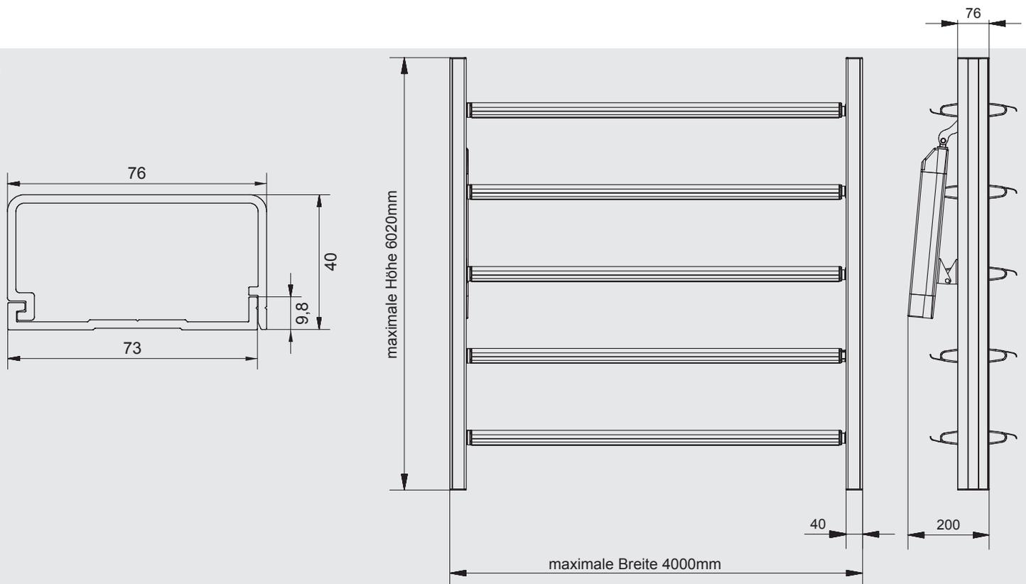
Die Lamellen und die Führungsschienen des Systems **Sunbreaker 210** sind aus extrudiertem Aluminium hergestellt.
