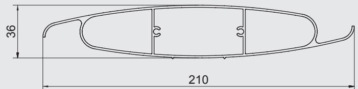
Die Lamellen vom Typ B sind zur Abdeckung horizontaler und vertikaler Flächen (Gebäudefassaden, Pergola-Wände) bestimmt. Die Form dieser Lamellen gewährleistet eine ästhetische Abschirmung gegen das Sonnenlicht.
